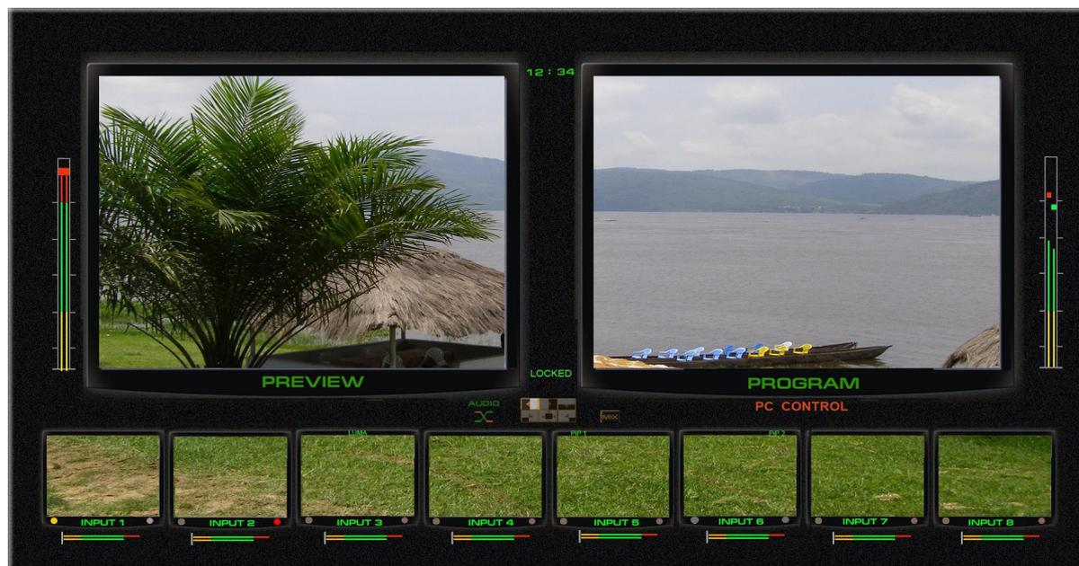
Экран мультиэкрана позволяет одним взглядом оценить текущее состояние микшера – какие сигналы включены на preset, программу, какие дополнительные сигналы наложены на выходной сигнал, какой сигнал готов к выдаче в эфир, информация об уровнях звукового сопровождения. Кроме того выводится вспомогательная информация - текущий спецэффект, ведение от сигнала внешней синхронизации и т.д.
