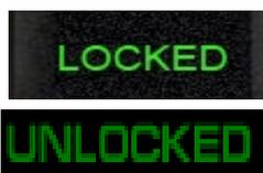
**Внешняя синхронизация.** Надпись Locked появляется в случае если микшер засинхронизирован внешним высокостабильным аналоговым синхронизирующим сигналом черного поля.. Если внешней синхронизации нет – появляется надпись Unlocked.
