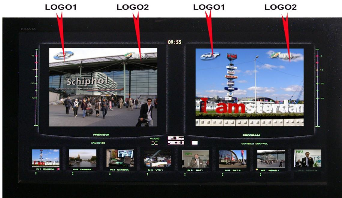
картинок в памяти микшера размером "128 x 96"). Каждый из логотипов можно располагать на экране в произвольном месте. Кроме этого, цифровые часы имеют отдельную настройку местоположения на экране. Включение и выключение логотипов производится с плавным микшированием.
